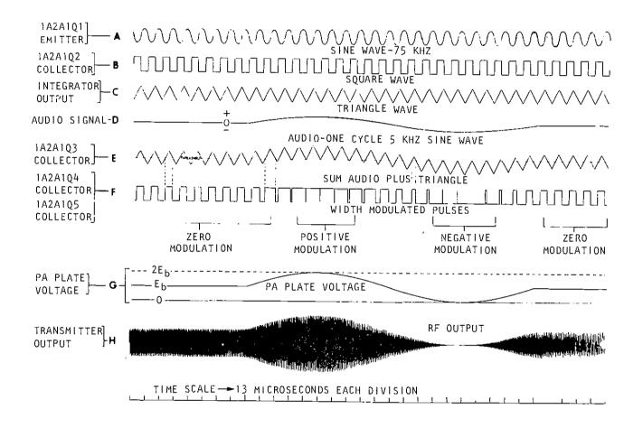
Figure 4-9. PDM Waveform
